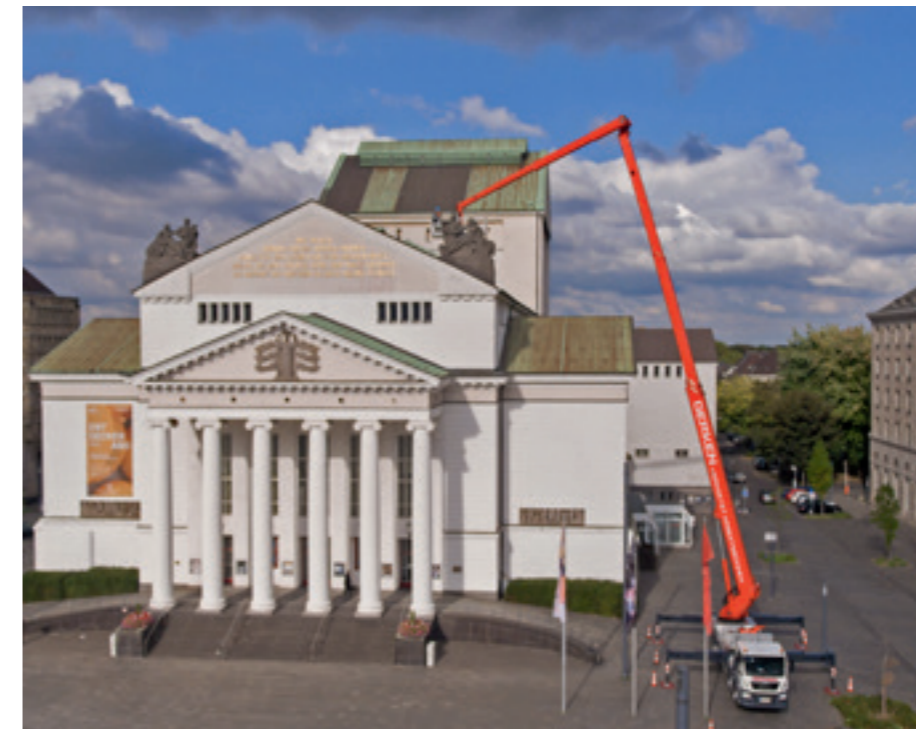
▲ Ab August im Gerken Mietprogramm: Die GL 18 L bietet weltweit als erste LKW-Arbeitsbühne einen emissionsfreien Betrieb über einen Lithium-Ionen-Akku an.
