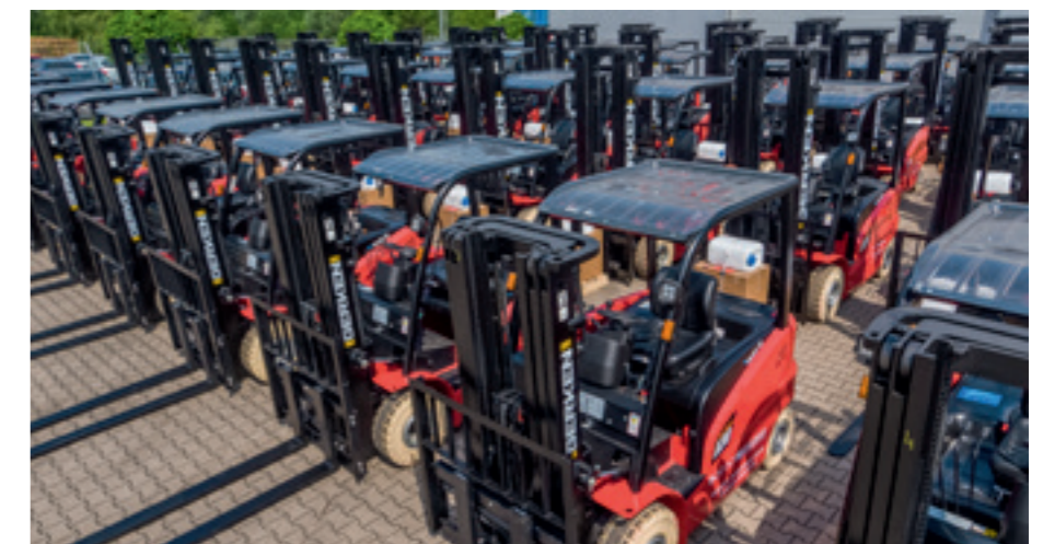
▲ 50 Gabelstapler vom Typ GST 61-30(E) W verstärken die Gabelstapler-Flotte von Gerken. Der Batterie-Stapler-Typ mit 6 Metern Hubhöhe und 3.000 kg Hublast ist bei den Gerken Kunden sehr beliebt.
