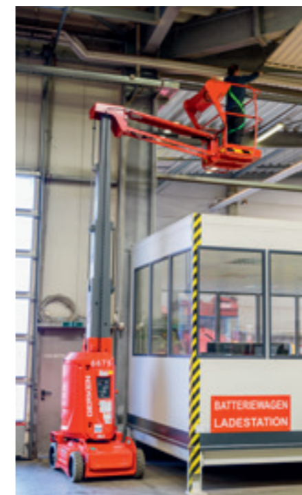
◀ Bewährte Technik aus Frankreich: 2017 wurden über 500 Haulotte-Maschinen in den Gerken Mietpark aufgenommen. Sie sind extrem zuverlässig und leistungsstark. Hier eine batteriebetriebene GTM 100-10 W, die innen und außen eingesetzt werden kann.
