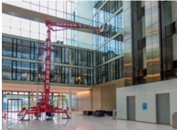
◀ Schmale Eingangstür und innen viel Raum mit großen Höhen: Die Spezial-Arbeitsbühne GSA 50 beherrscht beide Disziplinen und sorgt immer wieder für erstaunte und zugleich begeisterte Gesichter.
