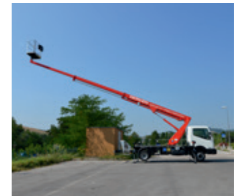
▲ Ab August im Gerken Mietprogramm: Die GL 18 L bietet weltweit als erste LKW-Arbeitsbühne einen emissionsfreien Betrieb über einen Lithium-Ionen-Akku an.
