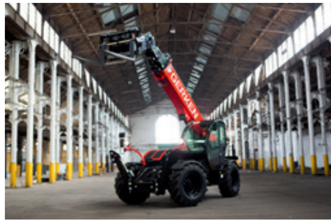
▲ Die neuen Haulotte-Teleskopstapler im Gerken Mietpark sind auch mit weißer abriebfreier Bereifung erhältlich. Die leistungsfähigen Maschinen hinterlassen selbst auf gebundenen Untergründen keine Spuren.
