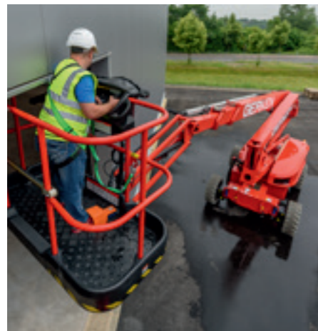
▲ Zahlreiche Gelenk-Teleskop-Arbeitsbühnen im Gerken Mietpark sind bereits mit einem aktiven Einklemmschutzsystem ausgestattet. Im Falle einer Unachtsamkeit bei der Bedienung helfen die Systeme, schwerste Verletzungen zu verhindern, indem sie die Maschine stoppen.
