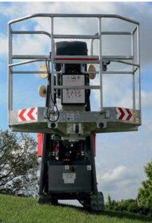
Die beiden neuen Spezialgerätetypen erreichen 14,69 bzw. 20,94 Meter Arbeitshöhe sowie 7,59 bzw. 12,26 Meter maximale seitliche Reichweite und bieten, entsprechendes Know-how des Bedieners vorausgesetzt, ein besonders breites Einsatzspektrum: Einerseits können sie im Gelände eingesetzt werden und dort große Hangneigungen ausgleichen, andererseits lassen sie sich selbst durch engste Passagen in Gebäude, wie z. B. Eingangsbereiche von Kaufhäusern, Kirchen oder Shopping-Centern, einbringen.
